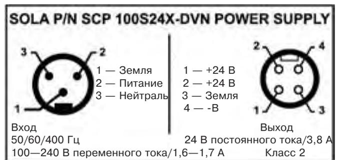
1. Соединение «0 Vdc» (0 В постоянного тока) имеет внутреннее заземление
