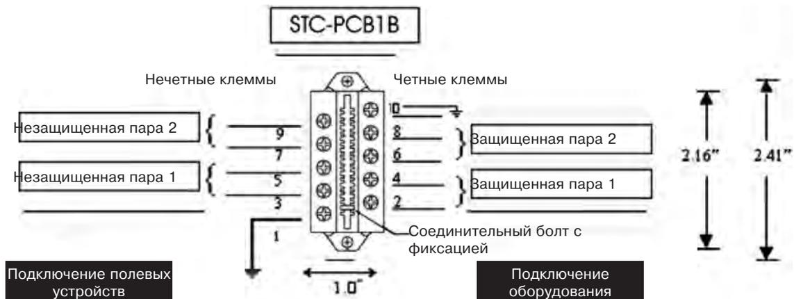
Клемма заземления 1 или 10 (внутренне соединенные) подключается к системе заземления здания. К устройству STC-PCB1B можно подключать провода калибром от 24 до 10 AWG.
